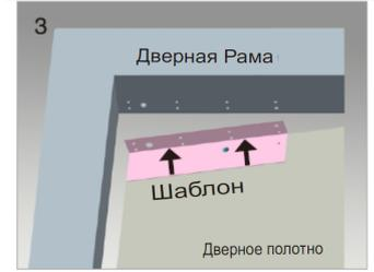
3 Отметьте положение винтов якорной пластины и магнитного замка на дверном полотне и дверной раме соответственно
