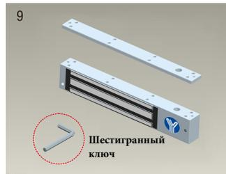
9 Используйте шестигранный ключ, что бы снять монтажную пластину с корпуса замка.
