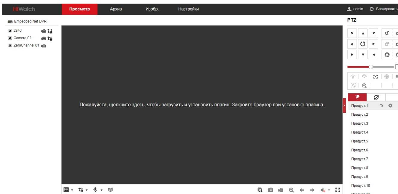
При первом входе в web-интерфейс, устройство попросит вас установить plug-in webcomponents для отображения web-содержимого. Скачивайте и устанавливайте компонент (при установке, браузер необходимо закрыть)
